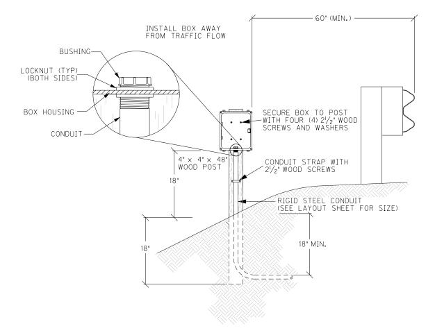
JUNCTION BOX/POST ASSEMBLY LOCATED BEHIND GUARDRAIL SHALL BE A MINIMUM OF 60" FROM THE FACE OF THE GUARDRAIL
